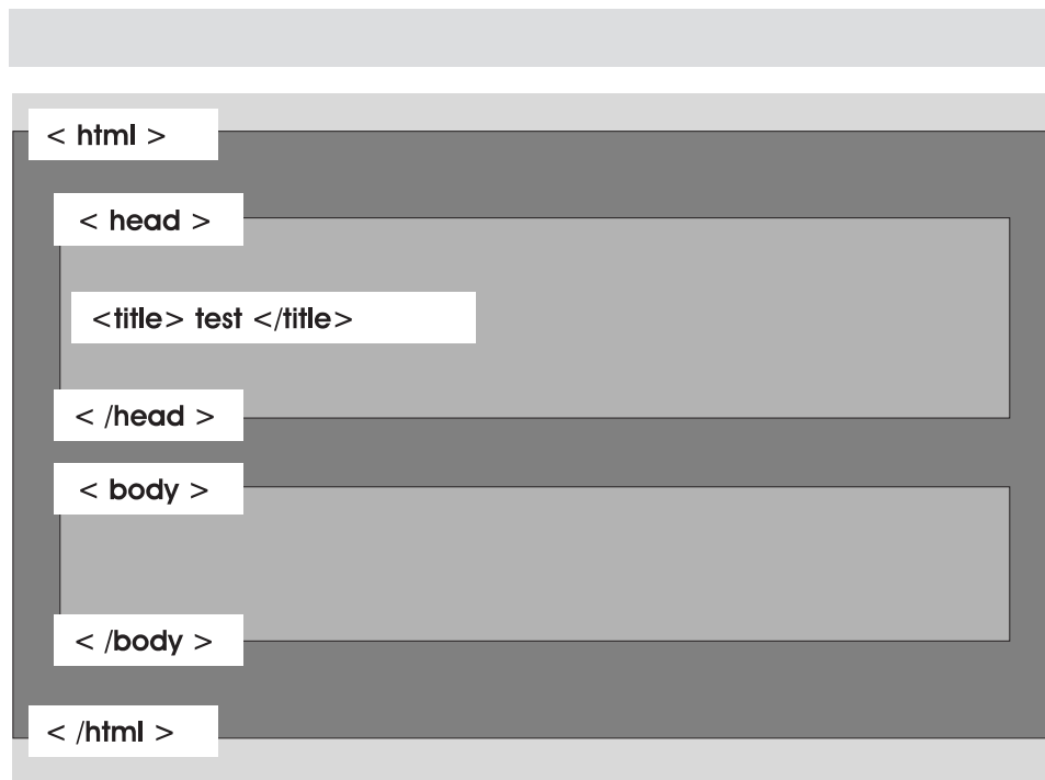
Рис. 2. Вложение элементов простейшего HTML-документа
